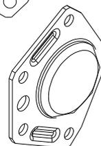
Tôle de fixation re renvoi de mouvement :
