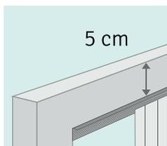
Ecoinçon minimum : 13 cm côté refoulement et 5 cm de côté passage piéton.
