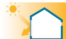
Pendant la journée, quand le soleil tape sur la vitre, un capteur d'ensoleillement commande la descente des volets roulants.
