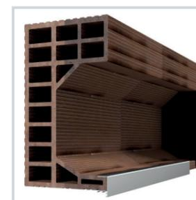
Bio'bric a développé une réservation en brique "CVR Collectif C35" spécialement adapté au Stylbloc. Sa forme générale de C permet de masquer totalement le volet roulant de l'extérieur. Il est posé par le maçon lors de l'élévation du bâtiment.
