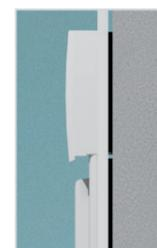
À l'intérieur, le bord du coffre est aligné avec l'ouvrant de la menuiserie.
